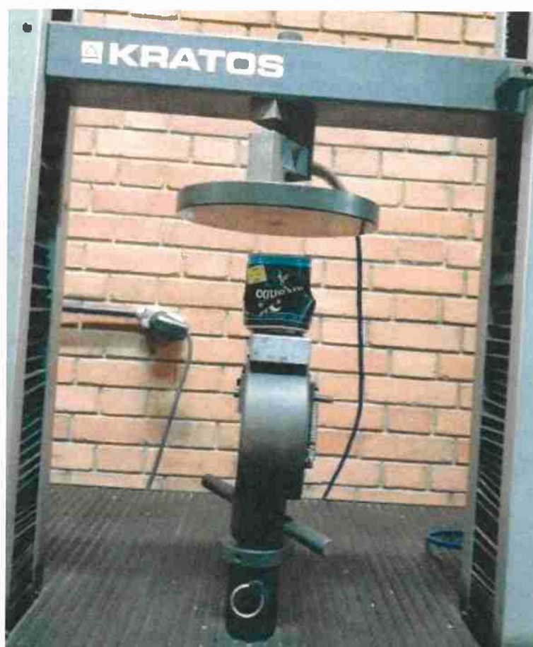
Figura 29: Lata de folha de flandres pós ensaio de compressão.
