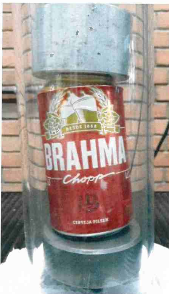
Figura 27: Lata de alumínio cheia durante teste de compressão.
