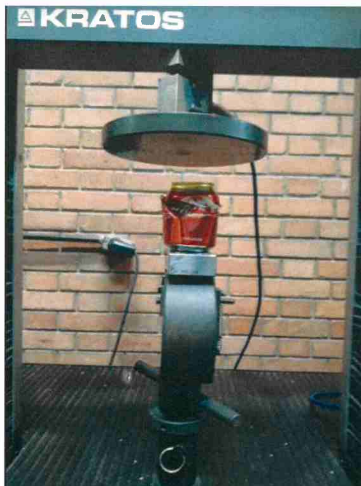
Figura 18: Esquema de montagem da máquina para o teste de compressão da lata de alumínio vazia.
