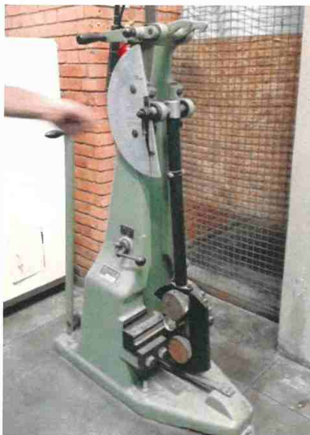
Figura 31: Ensaio de impacto Charpy.
