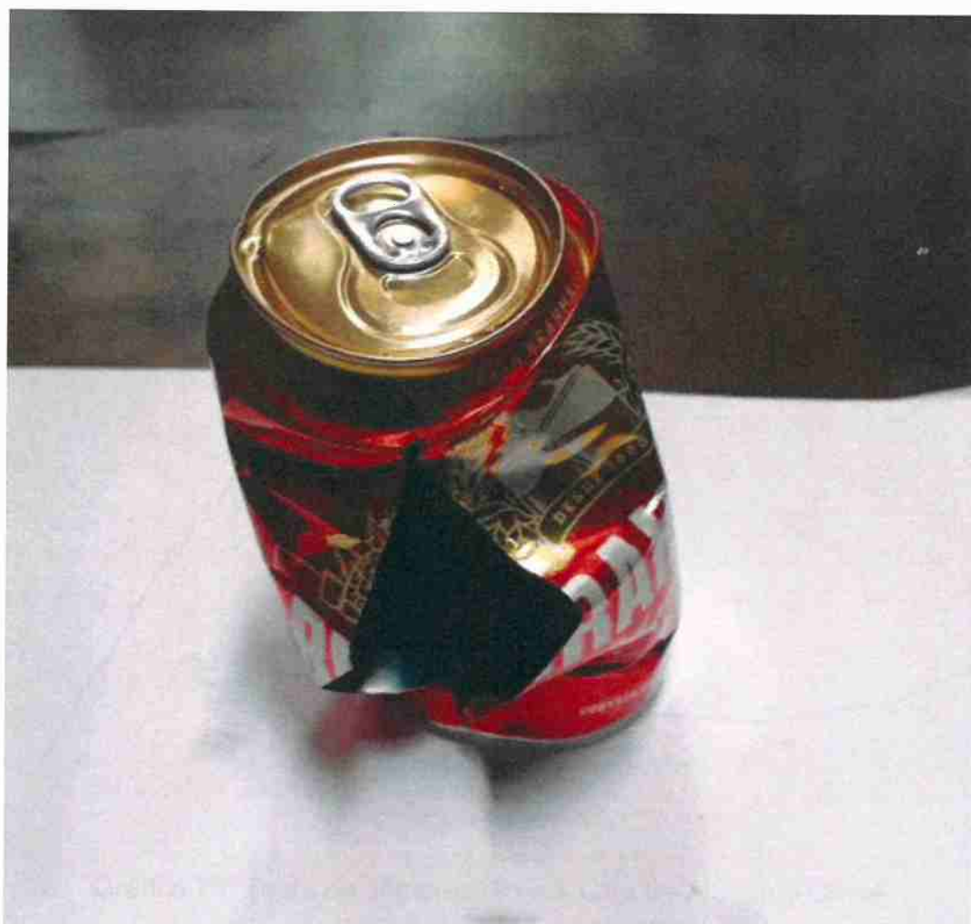
Figura 28: Lata de alumínio cheia pós teste de compressão.
