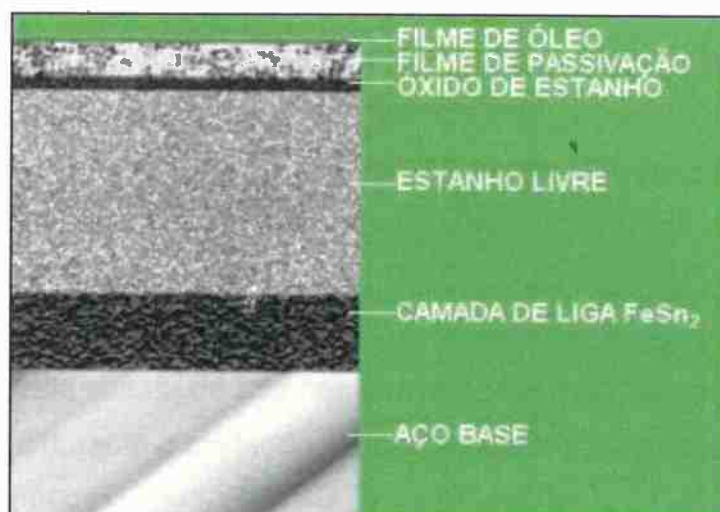
Figura 6: Composição da folha de flandres.
