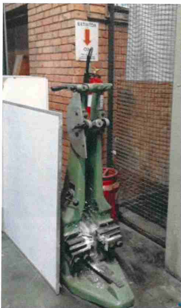
Figura 32: Teste de impacto Charpy sendo realizado na lata de alumínio cheia.
