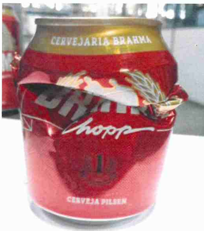
Figura 26: Lata de alumínio vazia após ensaio de compressão.
